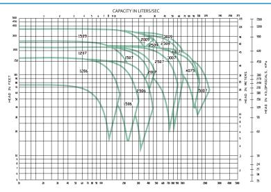
FLOW IN GALLONS PER MINUTE • 3500 RPM • CI QUICK SELECTION CURVE
