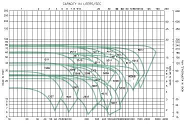
FLOW IN GALLONS PER MINUTE • 1160 RPM • FI QUICK SELECTION CURVE
