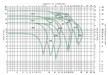
FLOW IN GALLONS PER MINUTE • 3500 RPM • FI QUICK SELECTION CURVE
